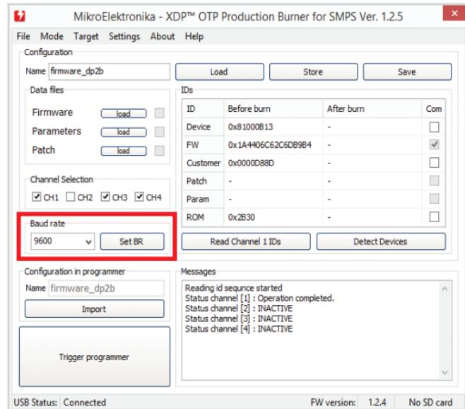
XDP™ OTP Burner 通过专门的单线通用异步收发传输器 (UART) 接口与开关电源 (SMPS) 器件进行通信。此
