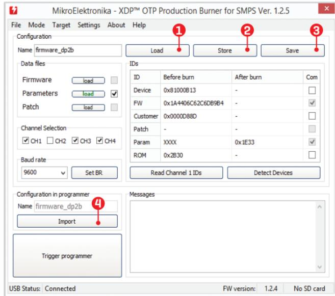
为了正确地设置 XDP™ OTP Burner，所选定的配置设置要通过点击“存储”按钮（Store; 2）存储在 XDP™ OTP Burner 中。成功执行之后，XDP™ OTP Burner 才能对目标器件进行编程。另外，用户也可以执行“导入”
