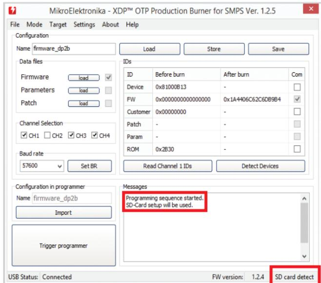
用户也可以用存储在 XDP™ OTP Burner 的外部存储中的配置执行编程过程。
