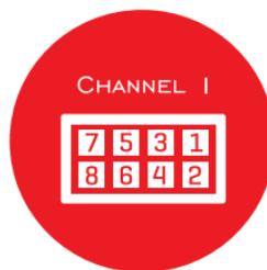
各通道拥有一个8引脚连接器（IDC8）。除了各通道的第六个引脚之外，其他七个引脚的功能都相同。各通道的第六针引脚指示一个总体事件；此信号指示不仅适用于一个特定的通道，亦适用于任何的通道。称为总体事件的各通道第六个脚的主要功能是使得用户把自选的外来电子电路连接到此设备，以对编程过程进行监督。这只是一种可选功能，未必属于普通使用方法。
