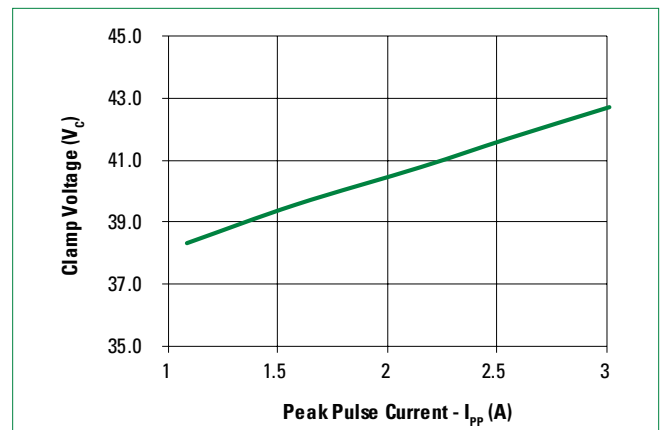
Clamping Voltage vs I_{PP}
