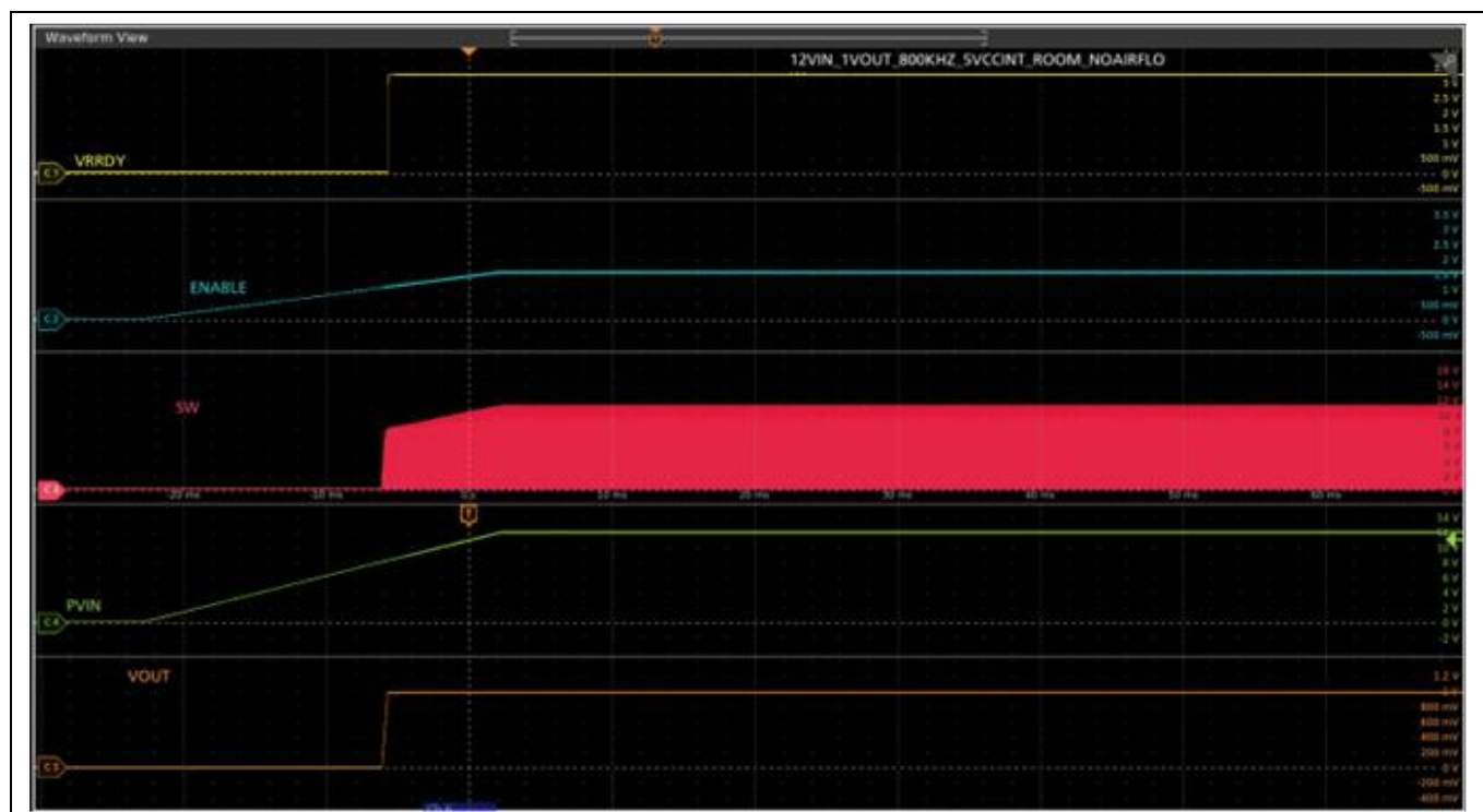
Figure 14 Start up at 30 A load (Ch 1 : VRRDY, Ch 2 : Enable, Ch 3 : Switch node, Ch 4 : PV_{in} , Ch 5 : V_{out} )
