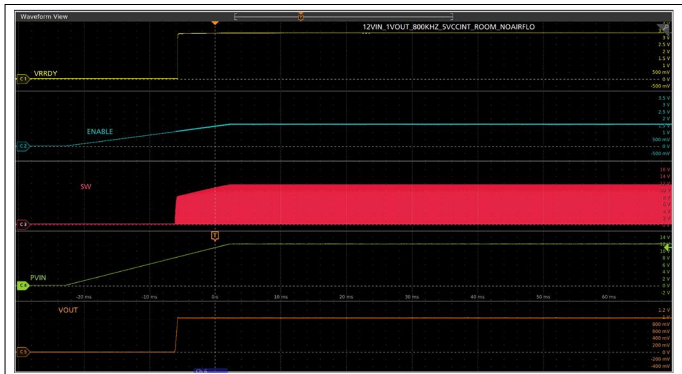
Figure 13 Start up at 0 A load (Ch 1 : VRRDY, Ch 2 : Enable, Ch 3 : Switch node, Ch 4 : PV_{in} , Ch 6 : V_{out} )
