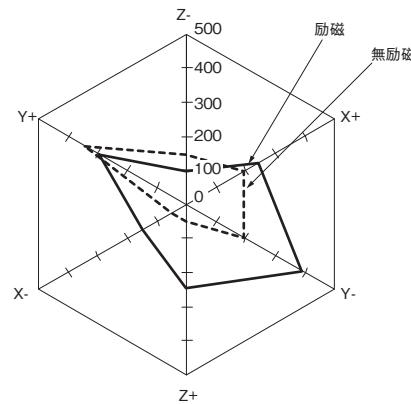
測定： 3軸6方向に各3回、衝撃を加え接点の誤動作を生じる値を測定。ただし、励磁電圧は保持電圧定格内とする。
