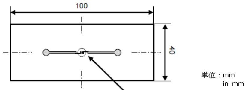
第5図 たわみ試験用基板
