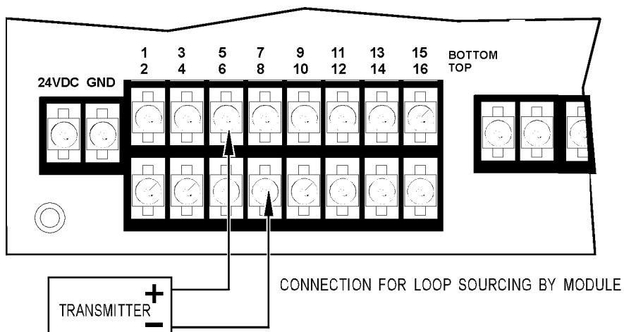
NOTE: PICTURE SHOWS CONNECTION FOR MODULE IN POSITION 1.
