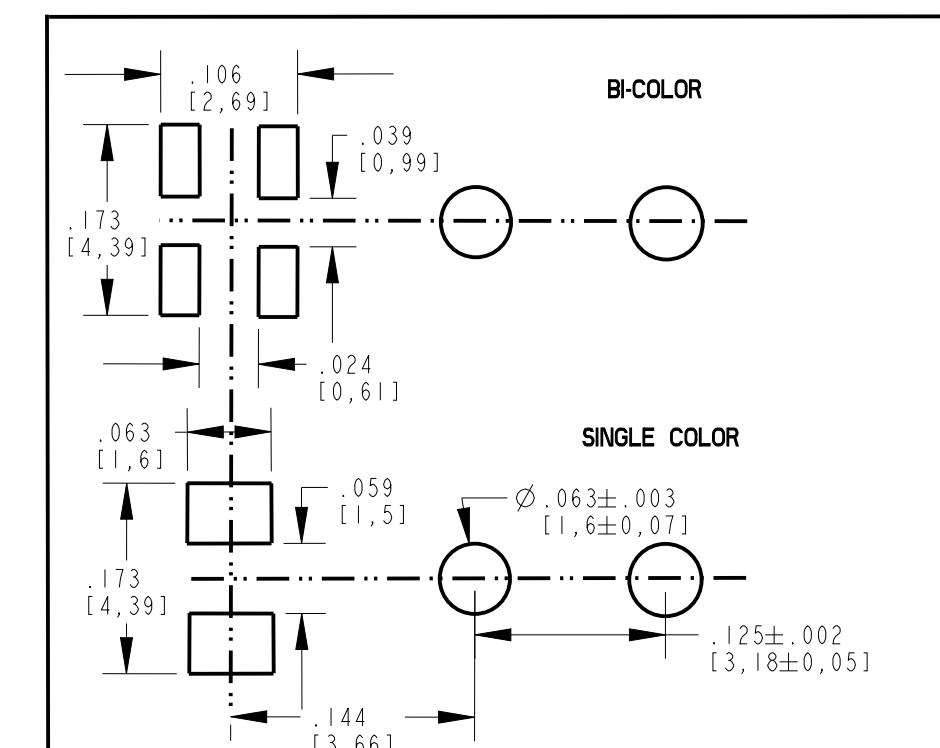
**RECOMMENDED HOLE PATTERN & SOLDER PAD LAYOUT**
