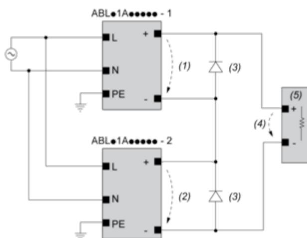
(1) :  $V_{out1}$ (2) :  $V_{out2}$ (3) : 2 x Diode,  $V_{RRM} > 2 \times V_{out1/2}$ ;  $I_F > 2 \times I_{nom1/2}$ (4) :  $V_{Load} = 2 \times V_{out}$
