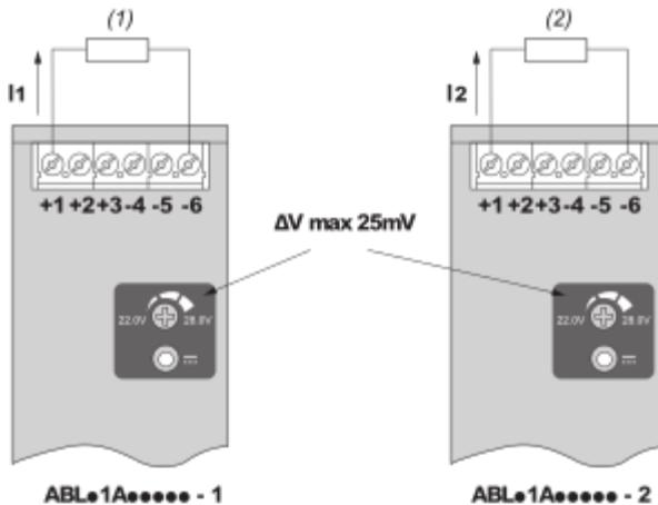
(1) :  $R_{Load1}$ (2) :  $R_{Load2}$
