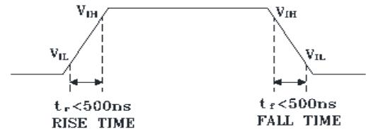
$$V_{IL} : (V_+ - 0.5) * 10\% \quad \text{FALL TIME : } t_f < 500\text{ns}$$
