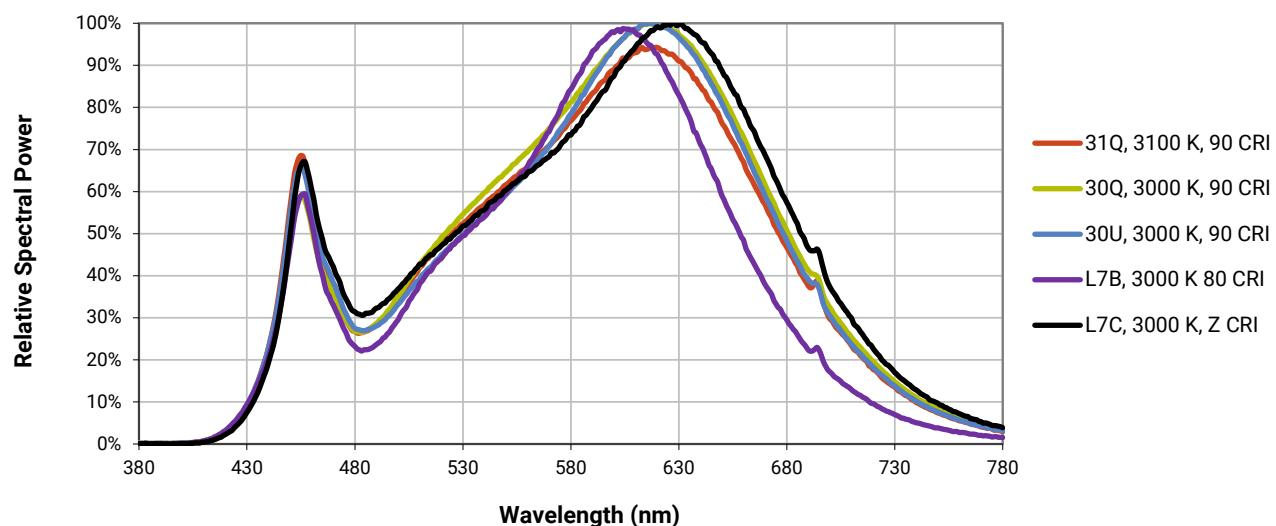
**RELATIVE SPECTRAL POWER DISTRIBUTION - ETONE™ LEDs**
