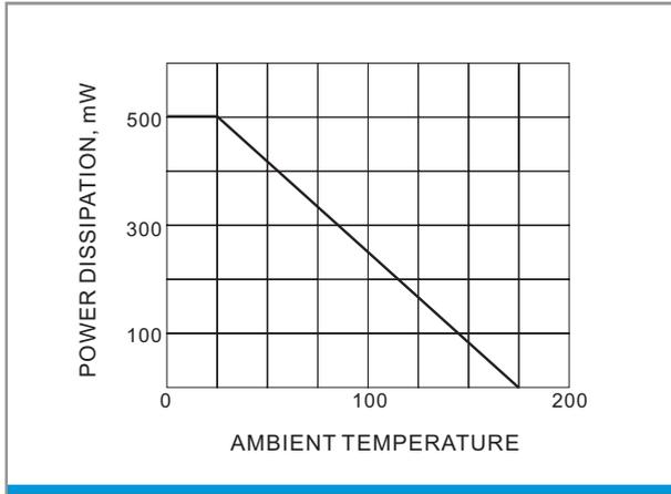
**Fig.4 DERATING CURVE**
